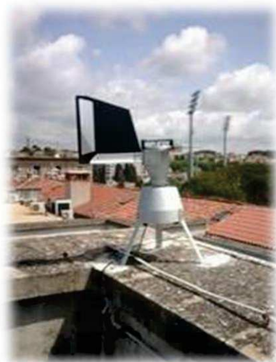
Slika 2. Aparat za uzorkovanje peludi
