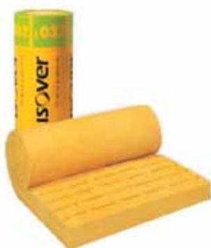
mineralna vuna u roli, komprimirana, elastična, sa vrlo niskim koeficijentom toplinske provodljivosti ( $\lambda = 0,032 \text{ W/mK}$ ), namijenjena za toplinsku izolaciju kuća sa izrazito niskom potrošnjom toplinske energije (pasivne, odnosno gotovo nul energetske kuće). Toplinsko-izolacijski materijali sa nižim koeficijentom toplinske provodljivosti, omogućavaju izradu dimenzionalno tanjih konstrukcija, uz zadržavanje iste razine toplinske izolacije (U-vrijednost).
