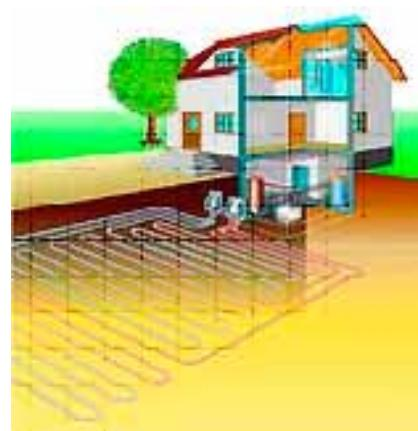
Uređaji niže kvalitete ne mogu zagrijati prostor kada je vanjska temperatura ispod nule, stoga treba odabrati dizalicu topline s inverterom koje mogu zagrijati kuću i pri vanjskim temperaturama od -15°C.
