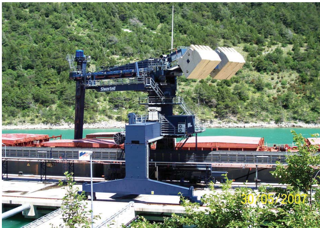
Slika 4.3-4: Kontinuirani pužni brodoiskrcivač Siwertell model ST 790-D
