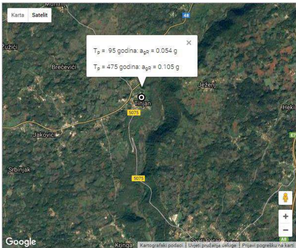
Slika 2. Horizontalna vršna ubrzanja tla tipa A ( a_{gR} ) za povratna razdoblja od T_p = 95 i 475 godina za područje Općine Tinjan
