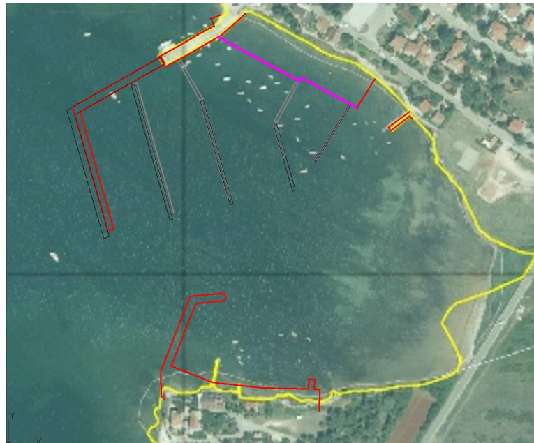
Grafički prikaz 4-50: Tlocrtna dispozicija obalnih građevina luka Karigador i Dajla-Belveder za numeričke simulacije; dispozicija objekata luke Karigador, analizirana u studiji 25G/18, označena je tankom crnom linijom
