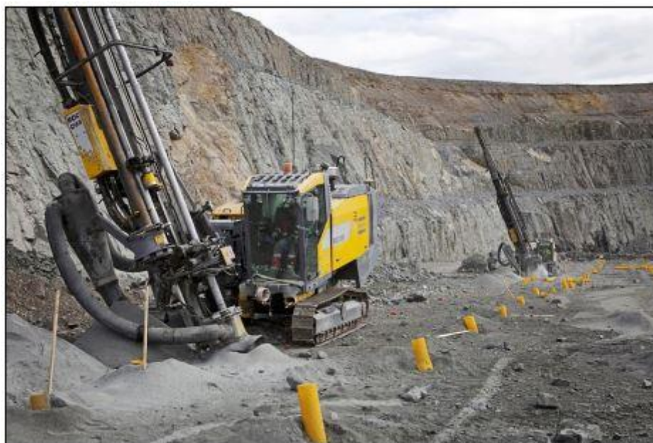
Slika 1./12. Bušilica za minske bušotine dužine do 25 m
