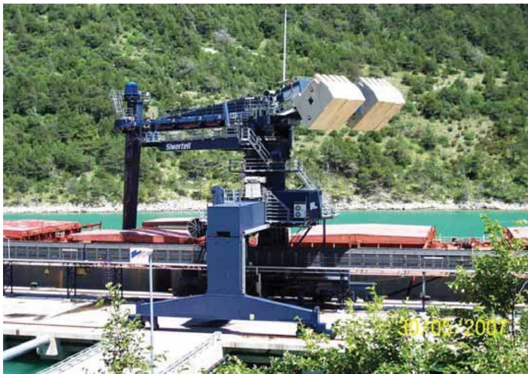
Slika 1.4.2-4: Kontinuirani pužni brodoiskrcivač Siwertell model ST 790-D
