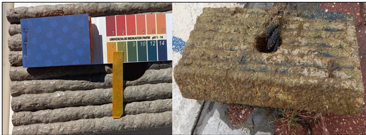
Slika 3. pH vrijednost betonskog elementa umjetnog grebena i obraštaj nakon 3 mjeseca u morskoj vodi
