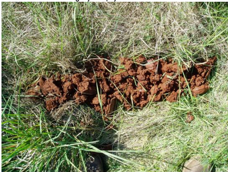
SLIKA 21. Morfološki izgled srednje duboke crvenice iz sondažne bušotine
