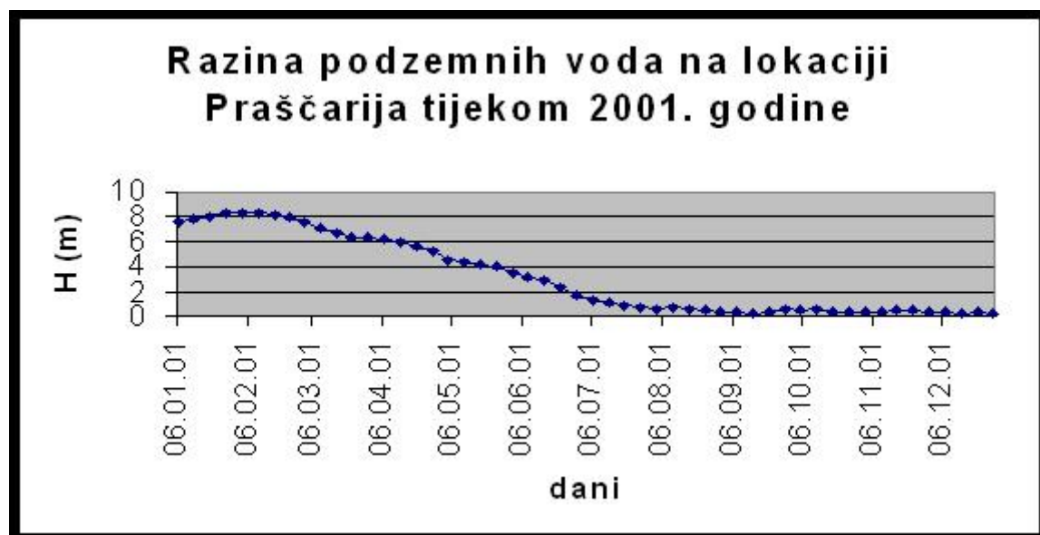
SLIKA 8. Usporedni dijagrami razina podzemnih voda na lokacijama Zidine i raščarija tijekom 2001. godine (GEO-5, fond stručne dokumentacije HV VGO Rijeka)
