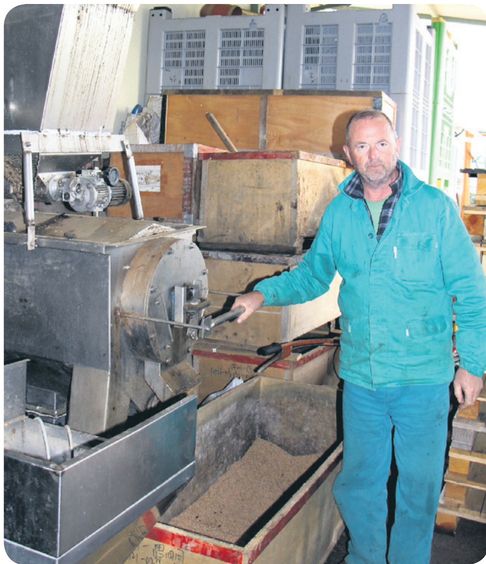
Dario Vigni uz separator za odvajanje koštica od komine
